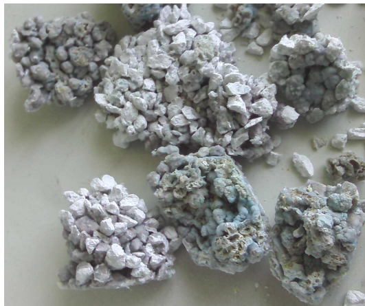
Рис. 2. Конгломераты спекшихся гранул кислородсодержащего продукта
