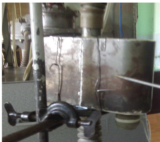
Рис. 9. Измерение температуры работающего патрона
