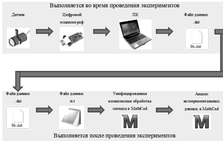
Рис. 2. Схема обработки сигнала датчика
