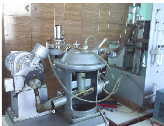
Рис. 3. Общий вид стенда-имитатора дыхания
