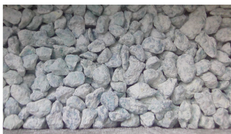
Рис. 13. Отработанные гранулы в случае неоднородно снаряженного патрона
