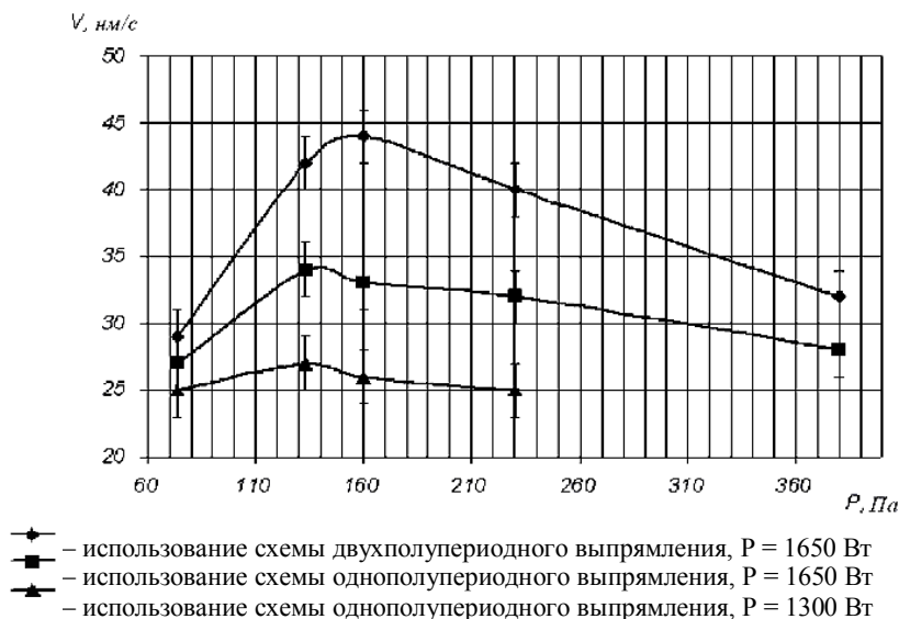
Рис. 2. Влияние величины давления O_2 в разрядной области на скорость удаления фоторезиста с поверхности кремниевых пластин для различных источников питания СВЧ-магнетрона
