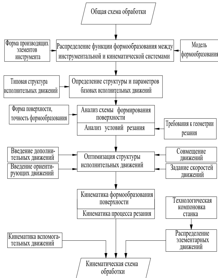
Рис. 5. Алгоритм синтеза кинематической схемы обработки
