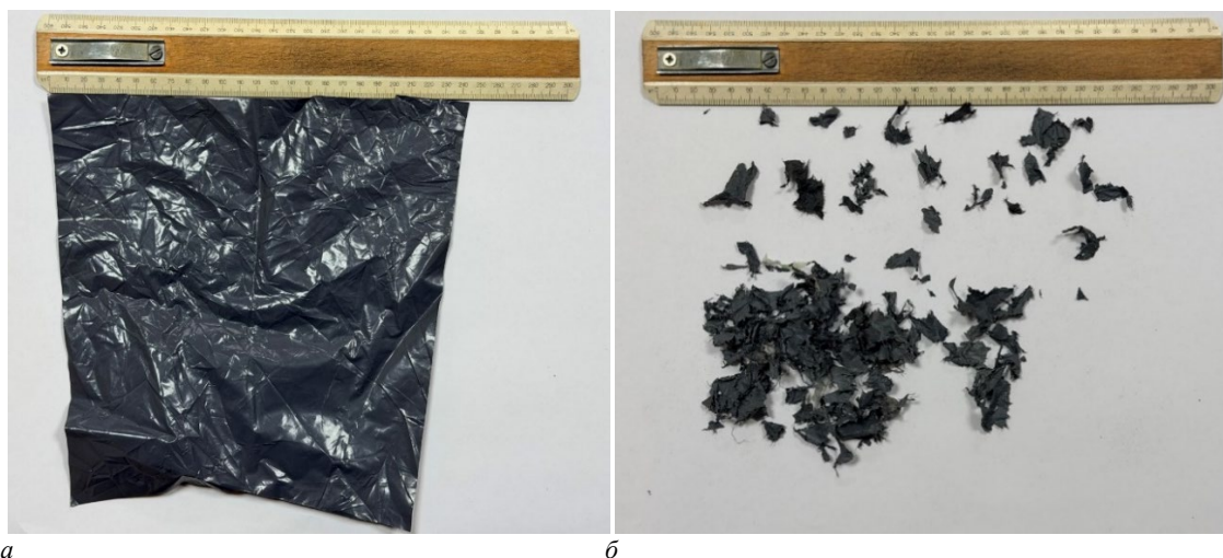
а – материал до измельчения; б – материал после измельчения
