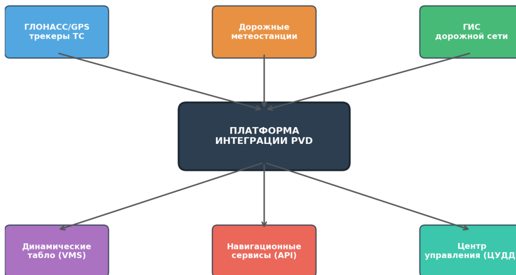
Рисунок 5. – Схема интеграции PVD с компонентами ИТС
