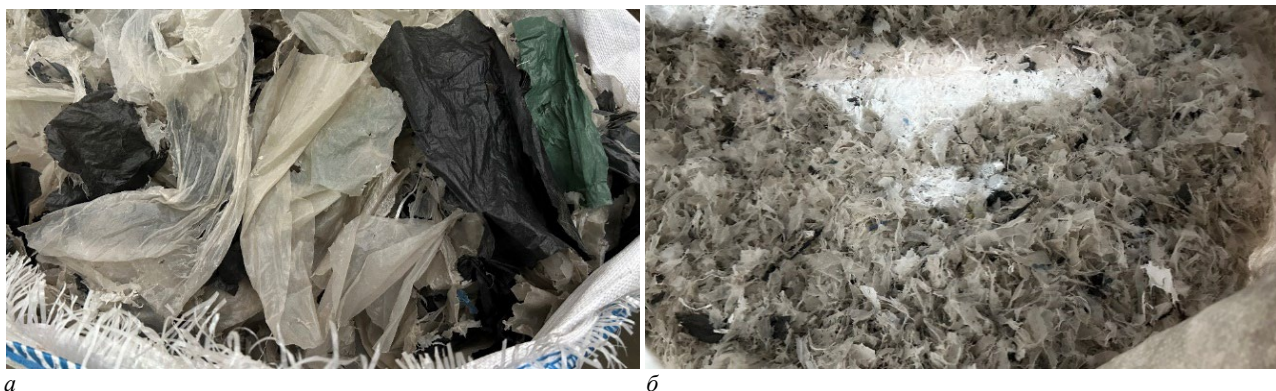
а – материал до измельчения; б – материал после измельчения
