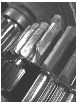
Рисунок 3. – Локальный дефект в 25% от длины зубчатого венца экспериментального зубчатого колеса z = 44
