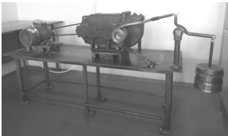
Рисунок 1. – Общий вид диагностируемого редуктора и используемого ленточного тормоза
