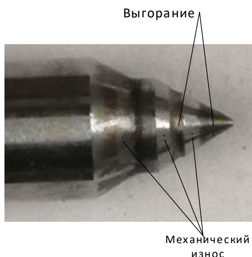
Рисунок 4. – Следы истирания и выгорания металла на игле распылителя
