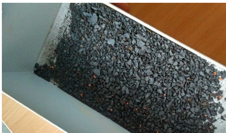
Рисунок 2. – Измельченный кокс в выгрузном бункере щековой дробилки
