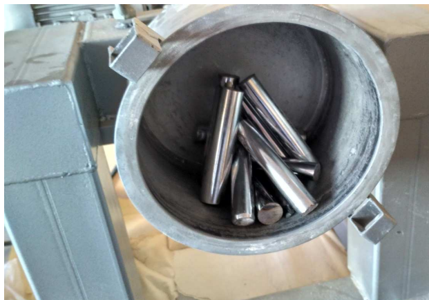
Рисунок 1. – Лабораторная барабанная мельница с цилиндрическими мелющими телами
