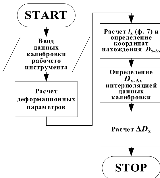
Рисунок 4. – Упрощенный алгоритм определения \Delta D_x для контрольного сечения, отстоящего от начала конуса деформации на расстоянии x ;
