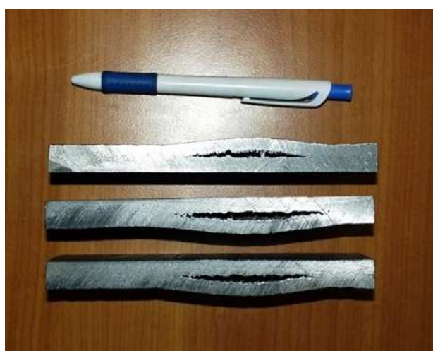
Рисунок 3. – Сероводородное расслоение стенки пропановой емкости
