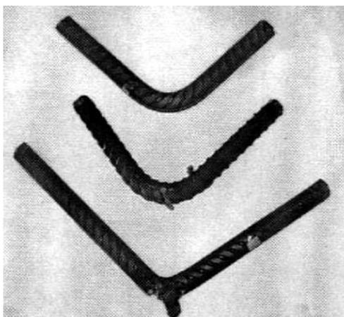
Рис. 6. Испытанные образцы из стали марки 35ГС
