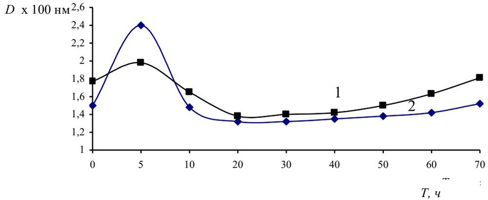
Рис. 3. Изменение среднего диаметра  $D$  дисперсных частиц битумов БН/10 (1) и БНД 90/130 (2) в зависимости от продолжительности  $T$  их термообработки.
