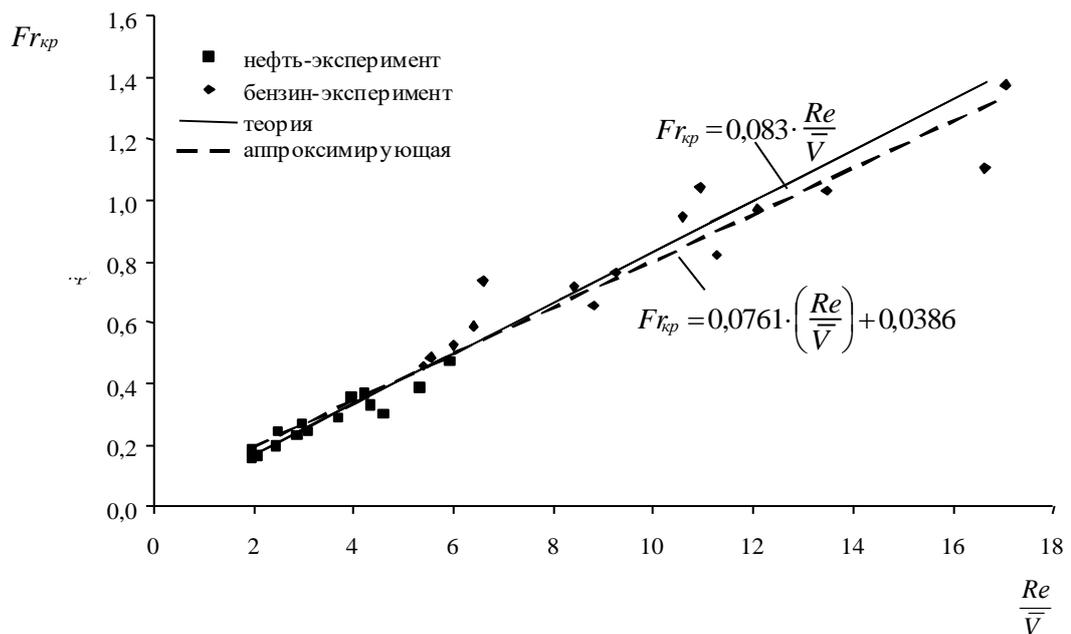
Рис. 5. График зависимости числа  $Fr_{kp}$  от  $\frac{Re}{V}$
