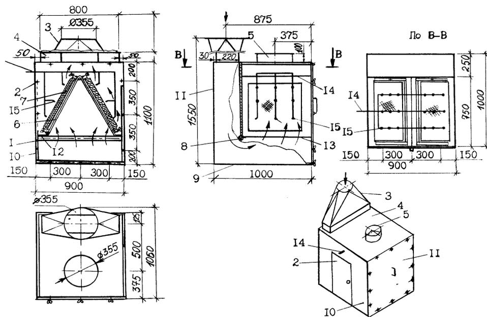
Рис. 1. Конструкция тканевого фильтра:
