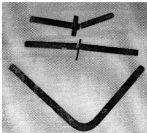
Рис. 7. Испытанные образцы из стали марки Ст3сп
