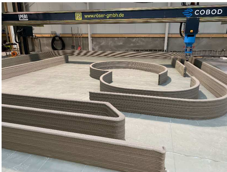
Рисунок 2. – Печать сборных конструктивных элементов в цеху
