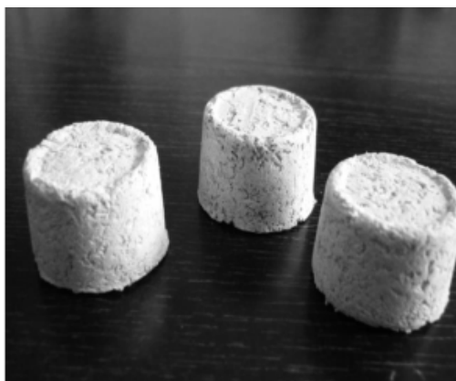
Рисунок 2. – Образцы, созданные с использованием тонкодисперсных гипсовых вяжущих
