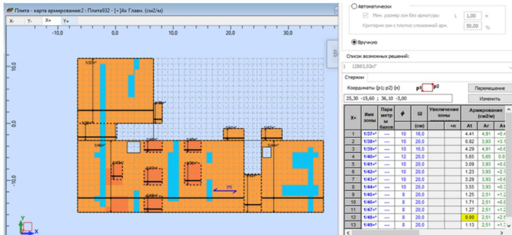
Рисунок 2. – Верхнее армирование плиты по оси X в ПК RSA
