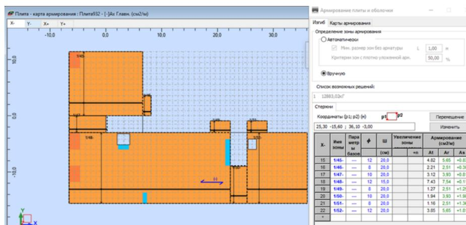
Рисунок 1. – Нижнее армирование плиты по оси X в ПК RSA
