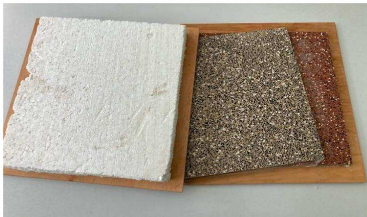
Рисунок 1. – Образцы наливного пола
