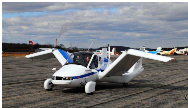
Рисунок 1. – Terrafugia Transition – летающий автомобиль со складными крыльями
