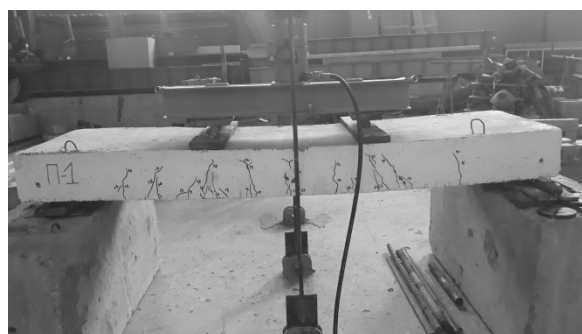
Рисунок 4. – Общий вид плиты П-1 после разрушения
