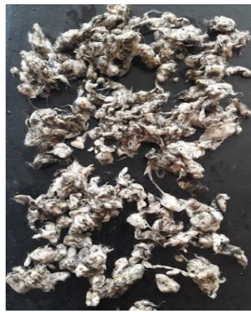
Рисунок 3. – Внешний вид необработанных волокон после появления следов плесени
