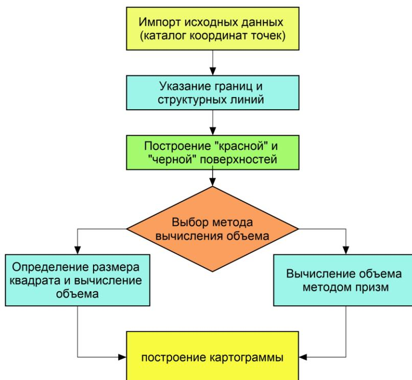
Рисунок 1 – Технологический процесс вычисления объёма
