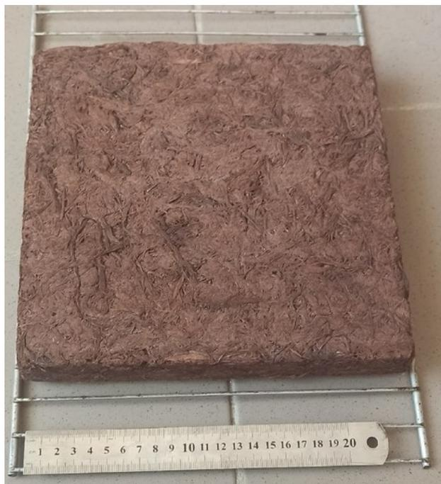
Рисунок 1. – Плита из волокон коры разбитых строительным миксером
