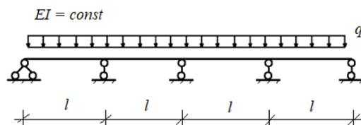
Рисунок 1. – Неразрезная балка
