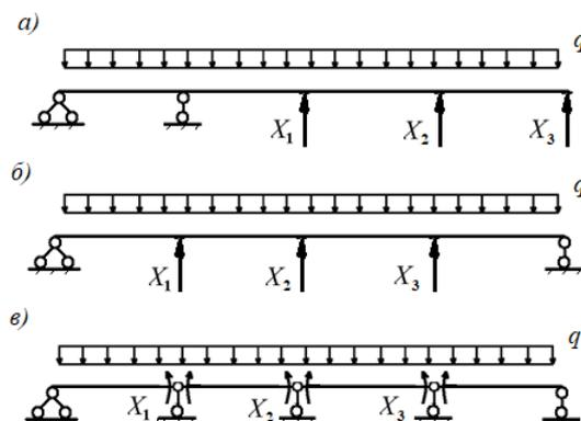
Рисунок 2. – Базовые варианты основной системы МС неразрезной балки
