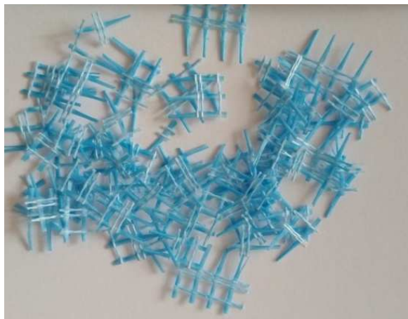
Рисунок 1. – Внешний вид отходов щелочестойкой стеклосетки ОАО «Полоцкстекловокно»
