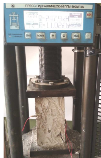
Рисунок 3 – Испытание бетонного образца с установленными в него глубинными датчиками
