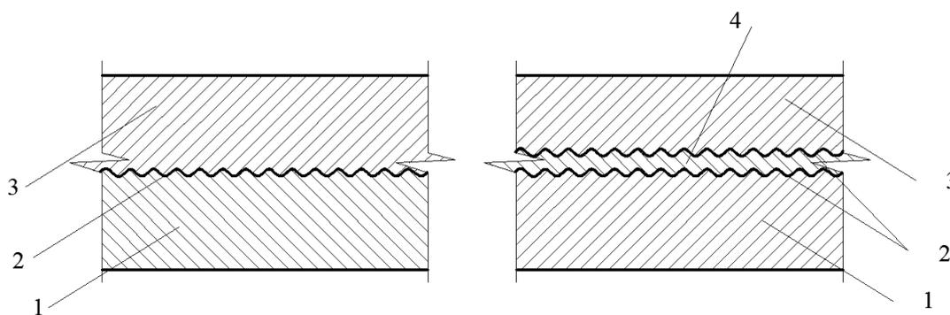
**1 – старый бетон; 2 – контактный шов; 3 – бетон намоноличивания;
