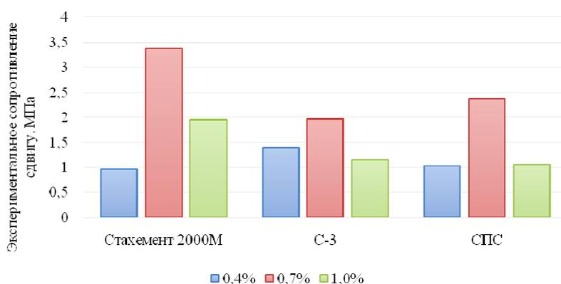
**Рисунок 2. – Изменение прочности контактного шва в зависимости от количества вводимого модификатора [2; 3]**
