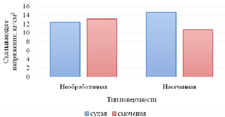
**Рисунок 1. – Влияние типа обработки поверхности на величину скальвающего напряжения в опытах К. Хагера и И. Нейнинга**
