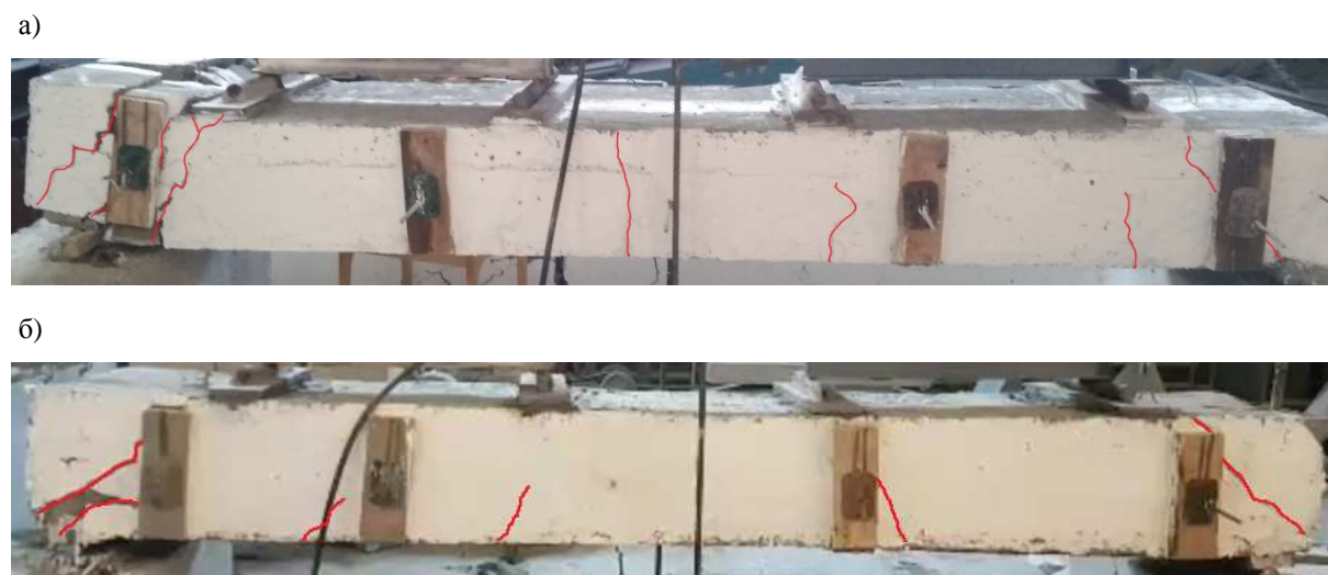
Рисунок 7. – Схема трещинообразования: а – плита I; б – плита II
