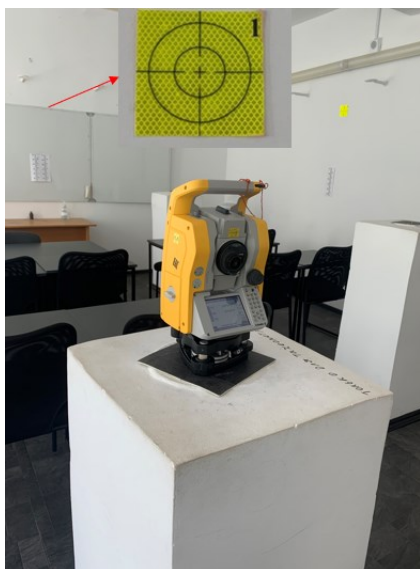
Рисунок 2. – Принудительное центрирование тахеометра
