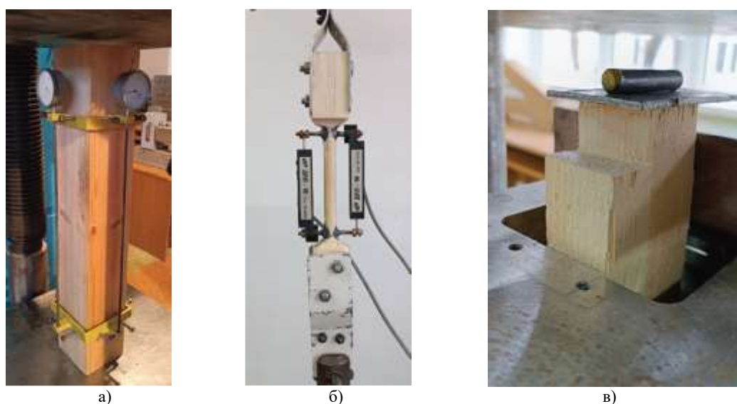
а) призмы, для определения модуля упругости; б) образца “восьмерки” при растяжении вдоль волокон; в) т-образного образца при сдвиге вдоль волокон
