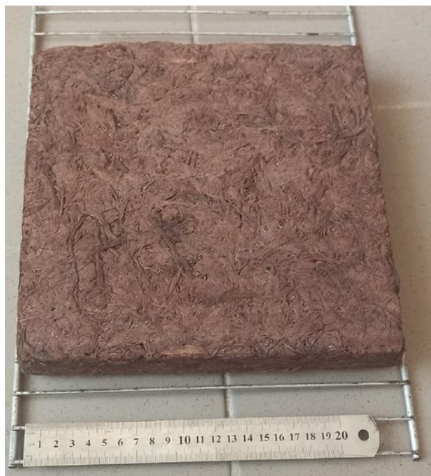
Рисунок 1. – Плита из волокон коры разбитых строительным миксером
