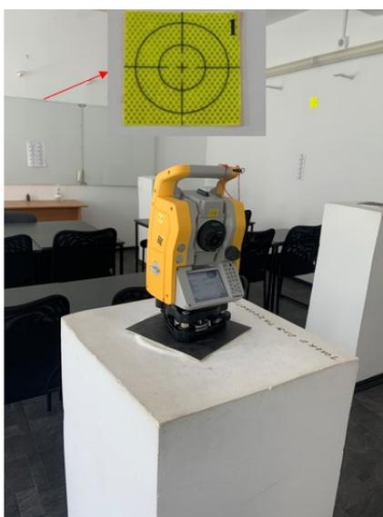
Рисунок 2. – Принудительное центрирование тахеометра
