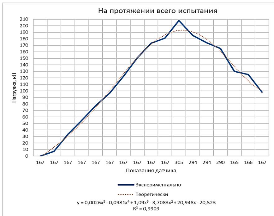
Рисунок 1 – Зависимость нагрузки от показаний глубинного датчика
