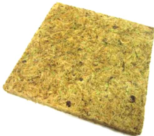
Рисунок 2. – Теплоизоляционные плиты из мха-сфагнома
