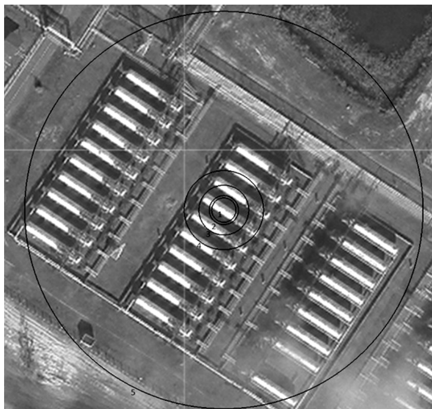
Рисунок 2. – Радиусы действия ударной волны при взрыве паров сжиженных углеводородных газов для подземных сооружений
