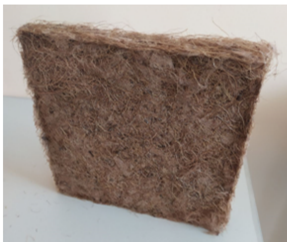
Рисунок 1. – Образец утеплителя на основе кокосовых волокон
