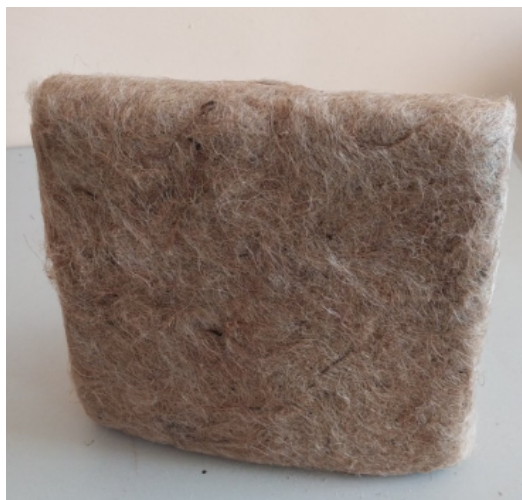
Рисунок 1. – Образец утеплителя на основе волокон джута
