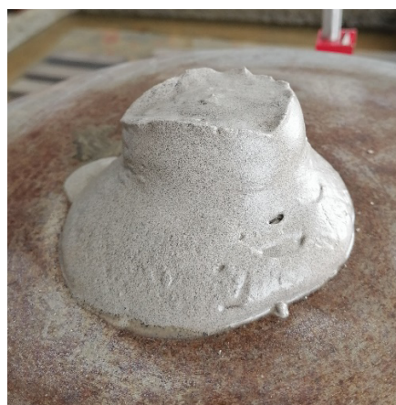
Рисунок 2. – Подвижность зологипсовой композиции с количеством воды затворения 60% от массы гипсового вяжущего при введении добавки Стахемент 2000-М в количестве 0,2% от массы гипсового вяжущего (состав 10)
