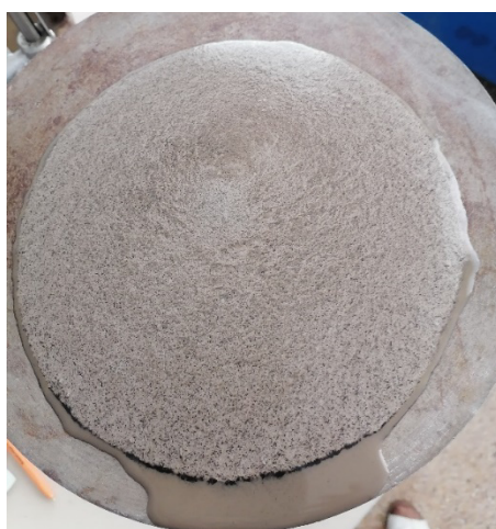
Рисунок 1. – Водоотделение при количестве добавки Стахемент 2000-М 0,4% от массы гипсового вяжущего
