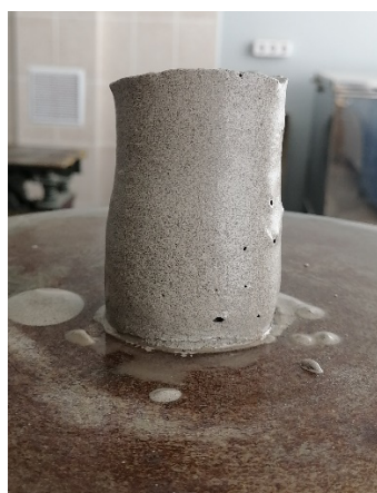
Рисунок 2. – Подвижность зологипсовой композиции с количеством воды затворения 60% от массы гипсового вяжущего при введении добавки Стахемент 2000-М в количестве 0,2% от массы гипсового вяжущего (состав 10)
