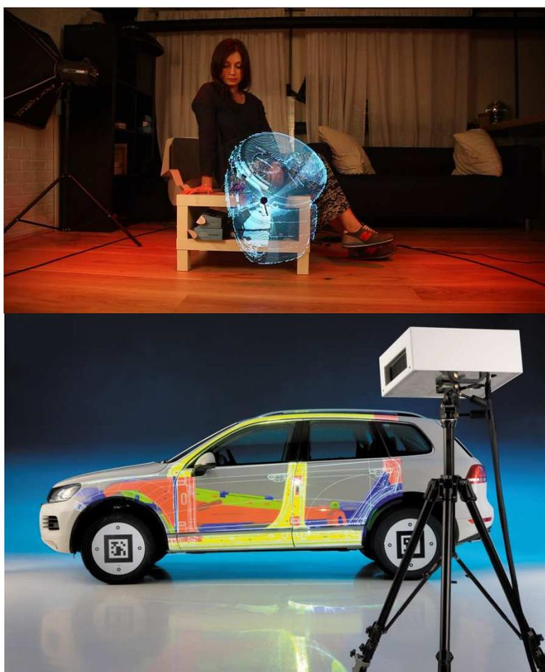
Рисунок 5. – Работа проекционных устройств дополненной реальности
