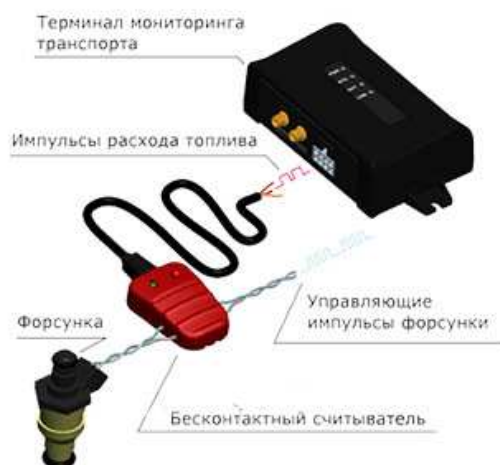
Рисунок 3. – Схема подключения CANCrocodile. в GPS-треккере
