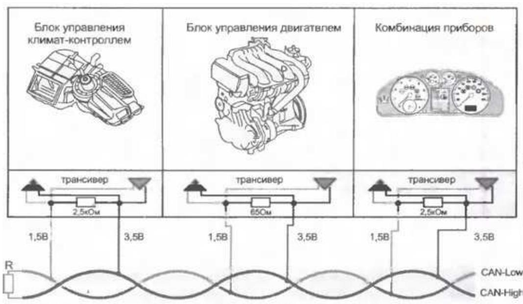
**Рисунок 3. – Подключение CAN-шины к блокам управления**
