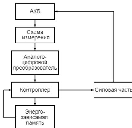
Рисунок 3. – Структурная схема силовой части и схемы измерения
