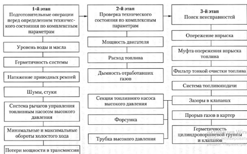
Рисунок 1. – Схема поэтапного диагностирования дизельного двигателя.
