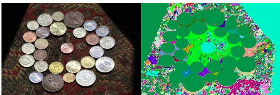
Рисунок 2. – Изображение после сегментации алгоритмом WaterShed
