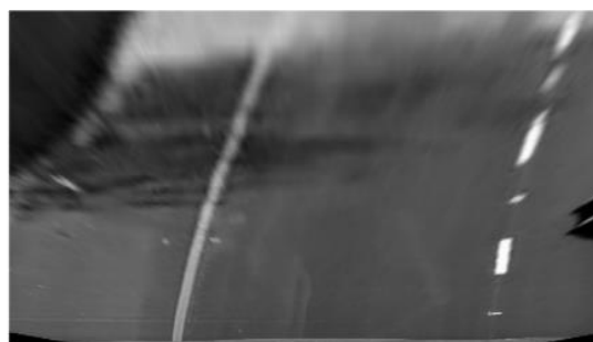
Рисунок 1. – Перспективная трансформация кадра видеопоследовательности изображения: а) до применения трансформации, б) результирующий кадр
