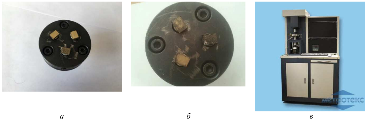
Рисунок 2. – Внешний вид образцов до (а), после (б) испытания и машины трения (в)
