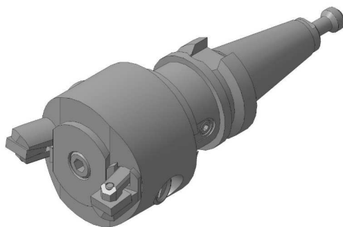
Рисунок 4. – 3D модель конструкции зенкера
