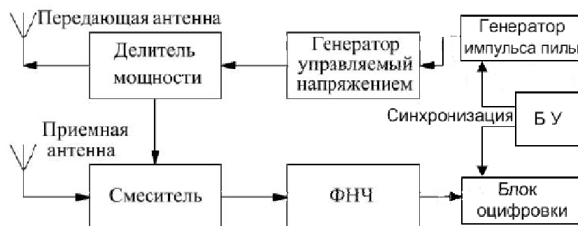
Рисунок 1. – Структура радиолокатора подповерхностного зондирования с формированием и обработкой сверхширокополосных квазинепрерывных ЛЧМ-сигналов
