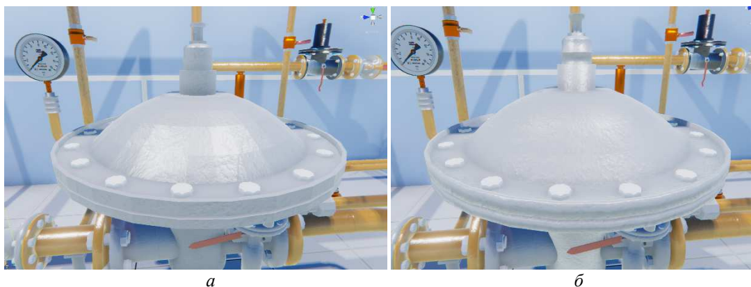
Рисунок 3. – Настройка UV Smooth для модели регулятора давления
