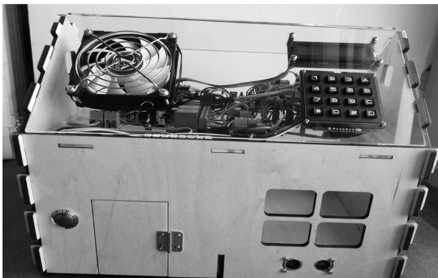
Рисунок 2. – Символьный дисплей и матричная клавиатура на макете
