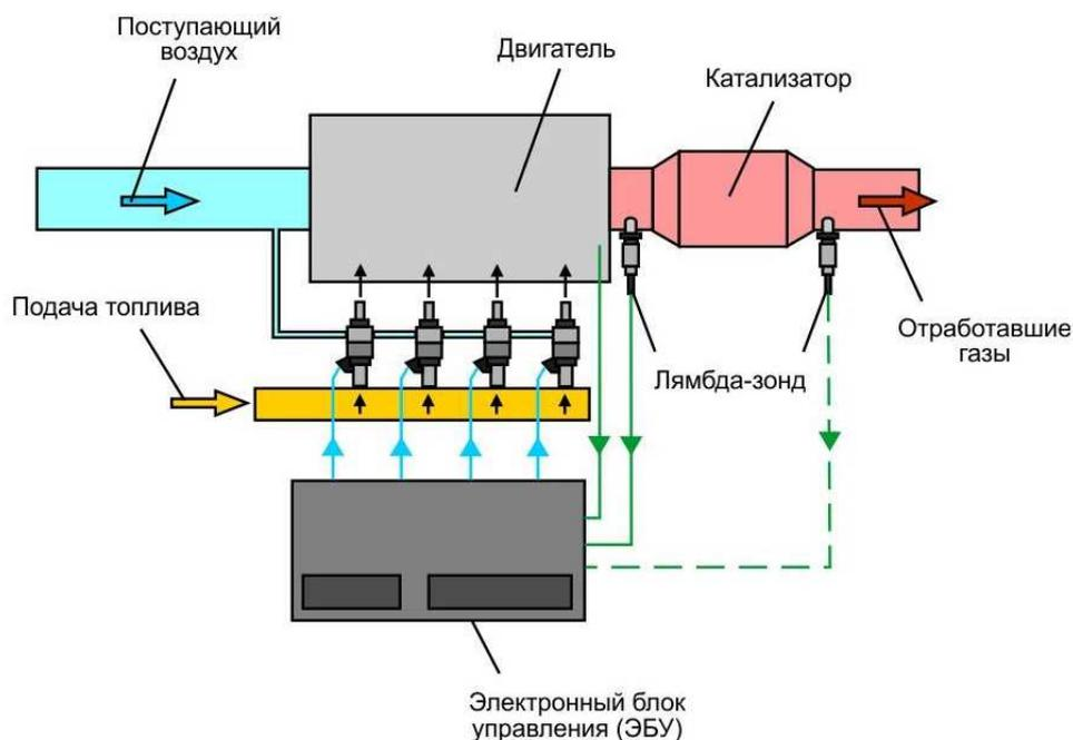
**Рисунок 1. – Схема установки  $\lambda$ -зонда
