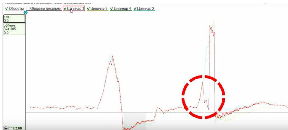
Рисунок 5. – Проблема с искрообразованием в 1-м цилиндре
