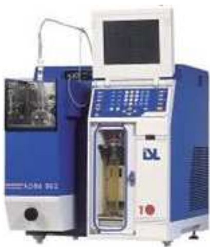
Рисунок 2. – Автоматический анализатор фракционного состава светлых нефтепродуктов AD86 5G (Франция)
