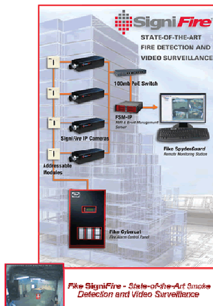
Рисунок 2. – Общая схема комплекса SigniFire [5]
