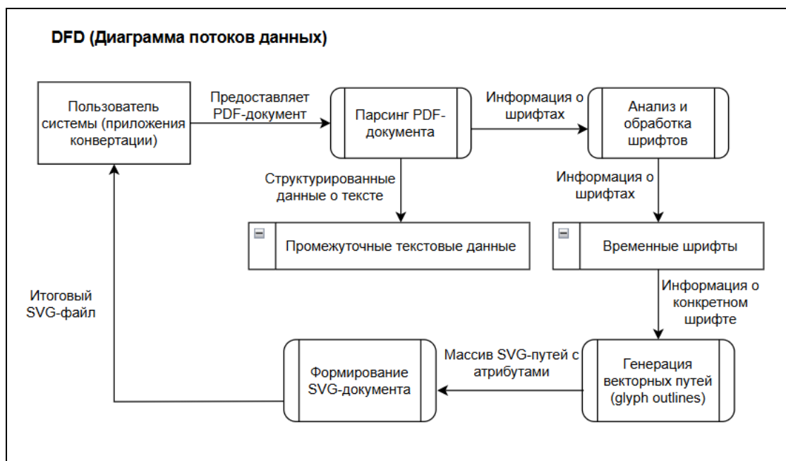
Рисунок 1. – Диаграмма потоков данных для приложения-конвертера
