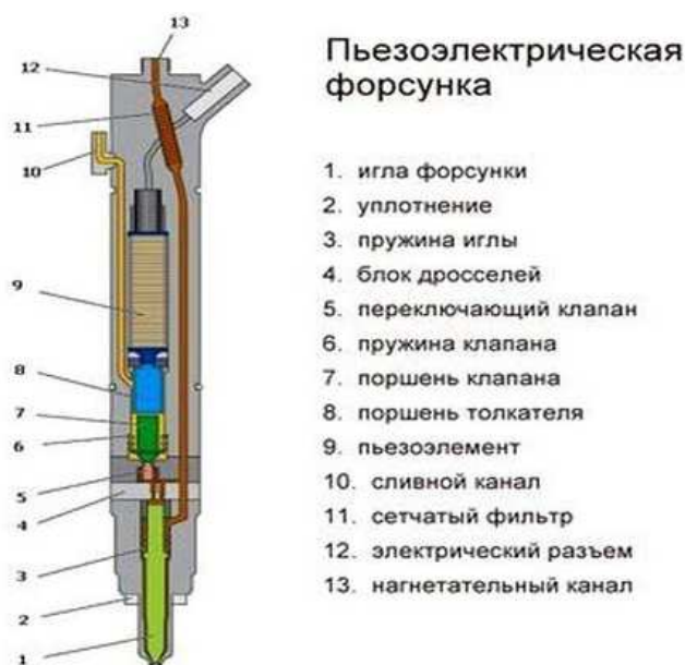
Рисунок 2. – Пьезоэлектрическая форсунка
