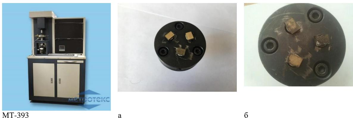
Рисунок 3. – внешний вид образцов после испытания на машине трения МТ-393:
