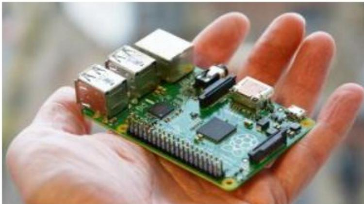
**Рисунок 1. – Одноплатный компьютер**
