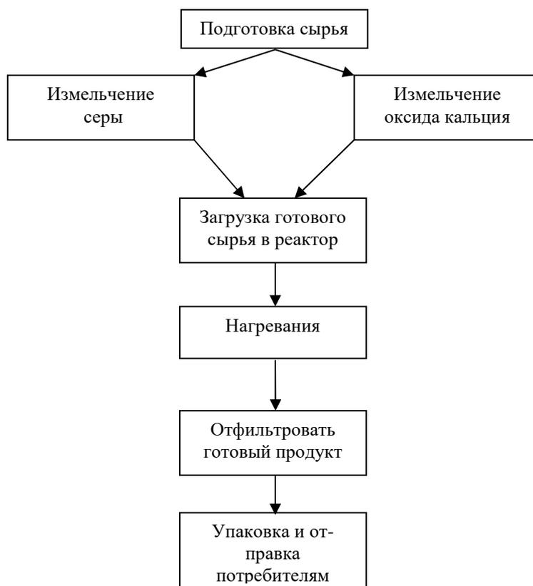
Рисунок 2. – Технологическая схема производства раствора полисульфида кальция
