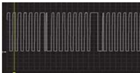
Рисунок 11. – График напряжения выходного сигнала датчика частоты вращения неисправного двигателя
