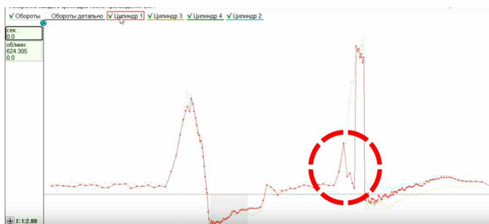
Рисунок 5. – Проблема с искрообразованием в 1-м цилиндре
