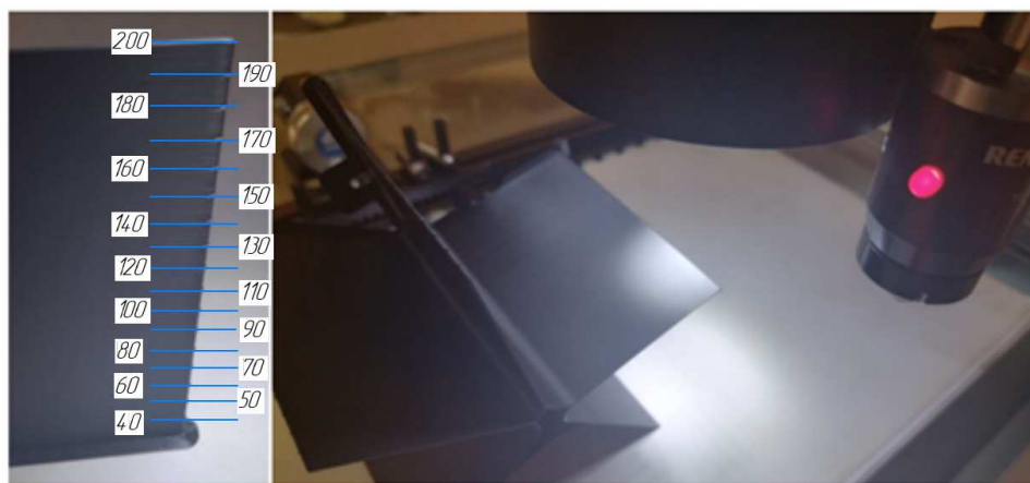
Рисунок 2. – Расположение тестовой модели на столе видеоизмерительного микроскопа
