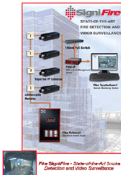
Рисунок 2. – Общая схема комплекса SigniFire [5]
